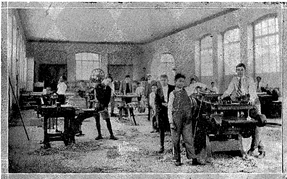
FÁBRICA DE CARPINTERÍA.—LOS ALUMNOS EN LA SECCIÓN A PRÁCTICANDO EN LA MACHIMBRADURA Y EN LAS SIERRAS CIRCULARES
